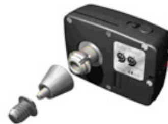
Figuur 2: Opbouw van een botverankerd hoortoestel
